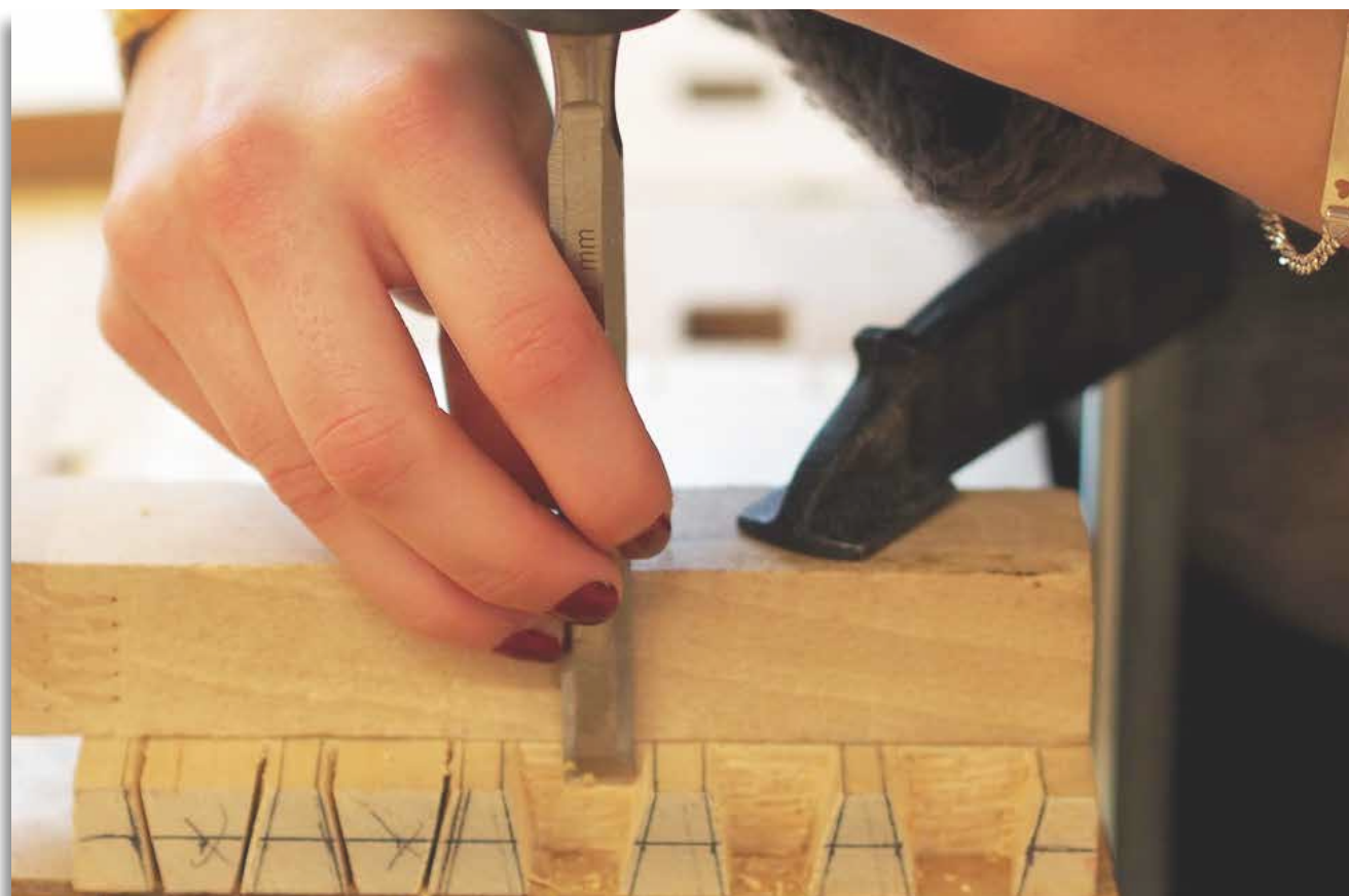
Ausstemmen einer Schwalbenschwanz-Zinkung im Tischlern der 10. Klasse
